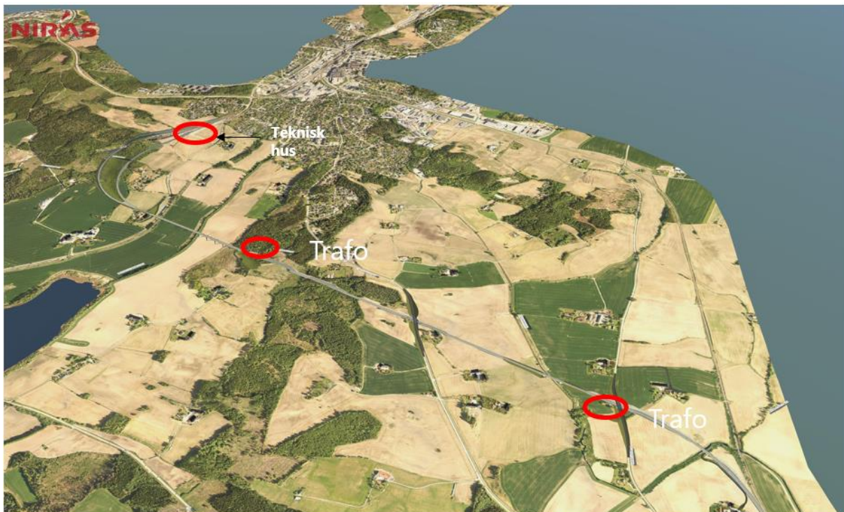
Figur 4-13 - Plassering av nytt teknisk hus og trafoer langs ny avgreining Østre linje
