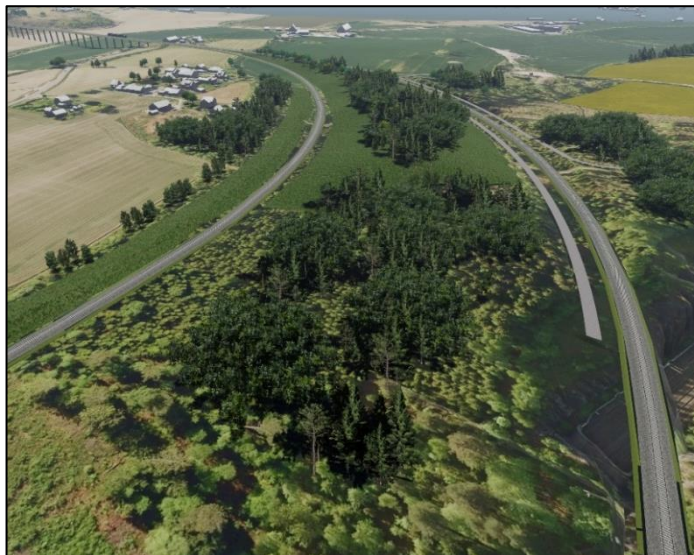
Figur 1-15 Område for planlagt masselager mellom jernbanesporene på Kjølsthøgda. Illustrasjon sett i fugleperspektiv mot sørøst. Det vises nytt terreng, utformet som små koller, og det reetableres skog som tilpasing til omgivelsene rundt.
