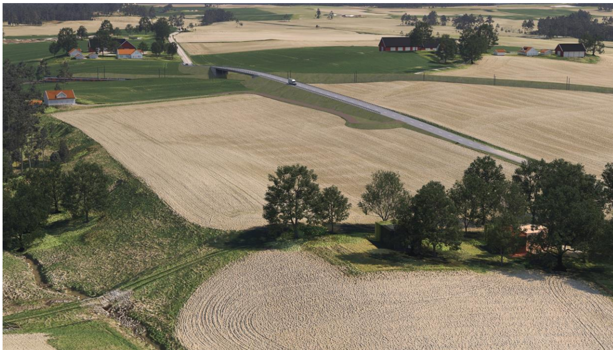
Figur 1-12 Illustrasjon som viser ny avgrening Østre linje i alternativ L1 ved Løkenveien sett mot nordøst. Løkenveien krysser over Østre linje i bru. Dagens adkomstvei til Vang gård, samt til Løkenveien 30, brytes av ny Østre linje. Ny adkomst til Vang er lagt lenger nord, mot Søndre Løken, ny adkomst til Løkenveien 30 vises på illustrasjonen.
